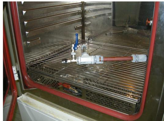
Foto 5 – prova di variazioni termiche / Photo 5 – Thermal variations test
