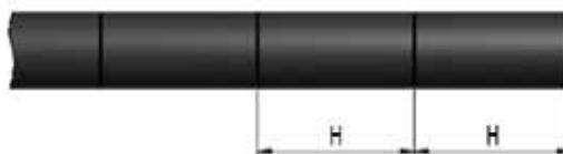
• Das Rohr muss im geraden Winkel oder darf höchstens bis zu einem Winkel von 10° abgeschnitten werden. Eine korrekte Verbindung ist erst dann erfolgt, wenn das Rohr die in Tabelle 2 angegebene Verbindungstiefe erreicht hat. Sollte das Rohr markiert sein, muss der Schnitt an der eingezeichneten Kerbe erfolgen.
